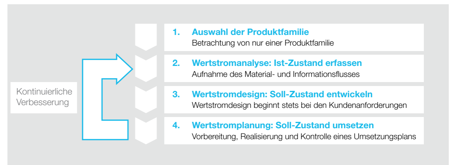
Abb. 8: Vorgehen bei der Durchführung eines Wertstromdesigns
